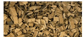
uniform chip chip size 10 mm ensartet flis flislængde 10 mm
